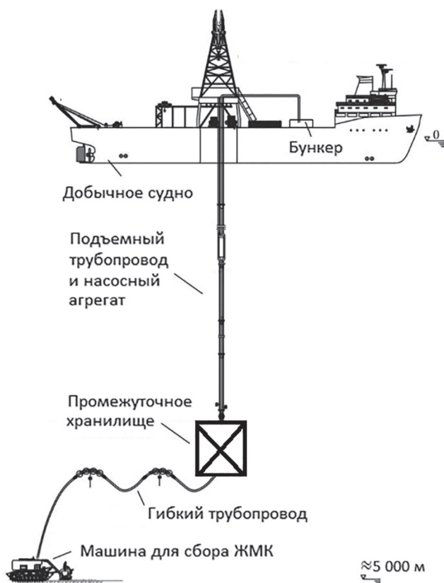
Рис. 3. Комплекс добычи на основе глубоководной машины для сбора ЖМК
