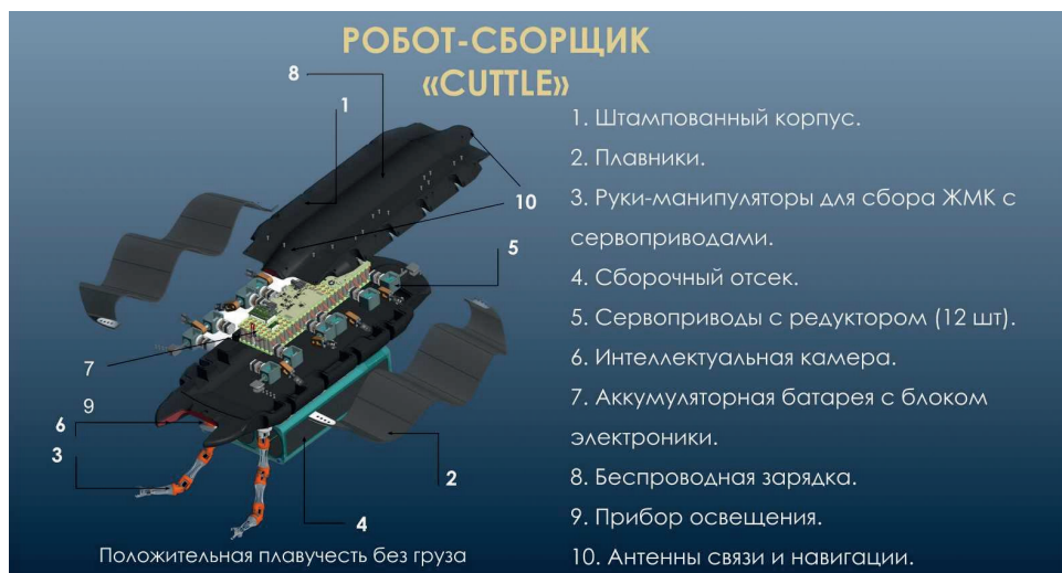
Рис. 4. Робот-сборщик разработки ООО ГИКО (ГИКО — глубоководная добыча..., 2023)
