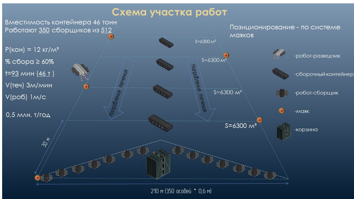
Рис. 5. Схема отработки участка конкреций компании ГИКО
