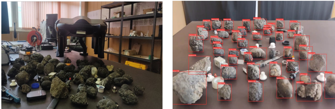
Рис. 7 Макет робота-сборщика и результаты распознавания конкреций.
